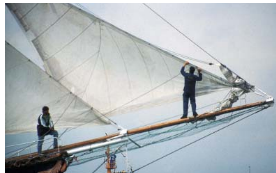
Im Jargon alter Seebären heißt er „Witwenmacher“ – der Klüverbaum. Bugsprit oder auch das „Vorgeschirr“. Wer zum Segelbergen bei schwerer See da vorne raus muss, macht einen einsamen Job, „Fahrstuhlfahren“ heißt das heftige Gefühl, aber bei schönem Wetter ist hier der beste Platz.
