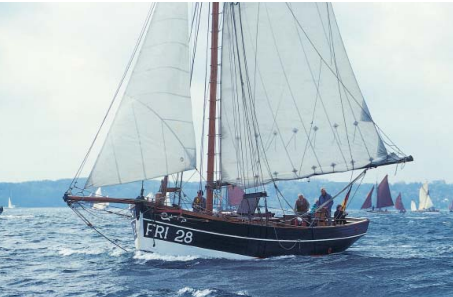
Fischkutter GRETE mit der typischen Kutternase: senkrecht. Auch dieser Kutter ist ein Nachbau nach historischem Vorbild. FRI zeigt den Heimathafen Friedrichskoog/Dithmarschen.
